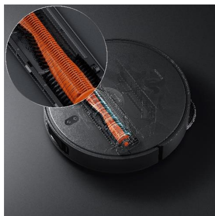
Konstrukce kartáče zabraňující zamotávání vlasů
