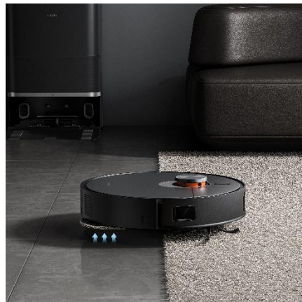
Automatická detekce koberce a automatické zvedání mopových podložek
